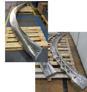
Bis zu 95 % des Halbzugs werden zerspannt (Beispiel Titanspant)
